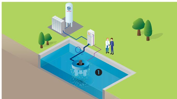
Os dois sistemas são de instalação rápida e fácil, podendo ser movimentados com uma grua. Os armários de controlo de energia e os armários de gás são colocados na proximidade dos reactores. Um sistema de monitorização que utiliza um sensor de oxigénio dissolvido permite otimizar a quantidade de oxigénio transferida para as águas residuais.
